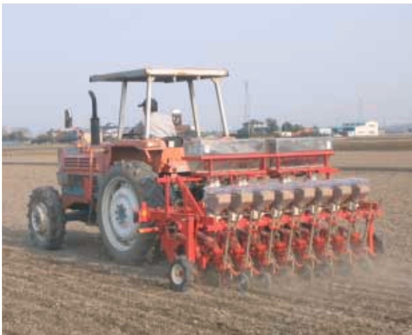
写真5 汎用型不耕起播種機による水稻不耕起乾田直播作業
