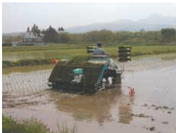
写真3 側条施肥田植機による移植。なお、苗には殺虫・殺菌剤が散布しており、また、田植機の後部において移植同時に除草剤が散布される
